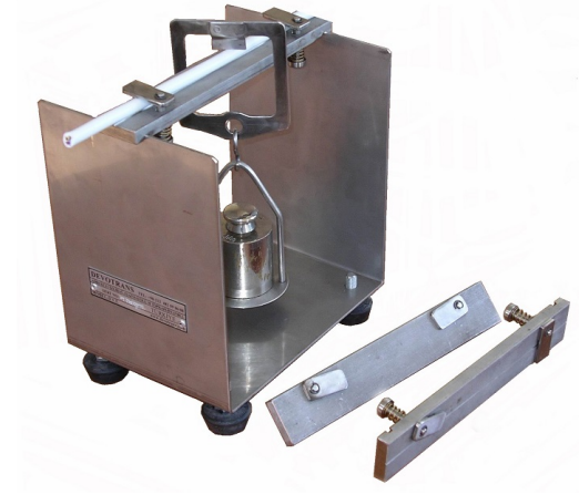
DVT KBS – Yüksek sıcaklıkta basınç deneyi cihazı
