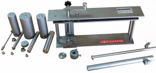
DVT KSB – Kablo soğukta bükme test cihazı
